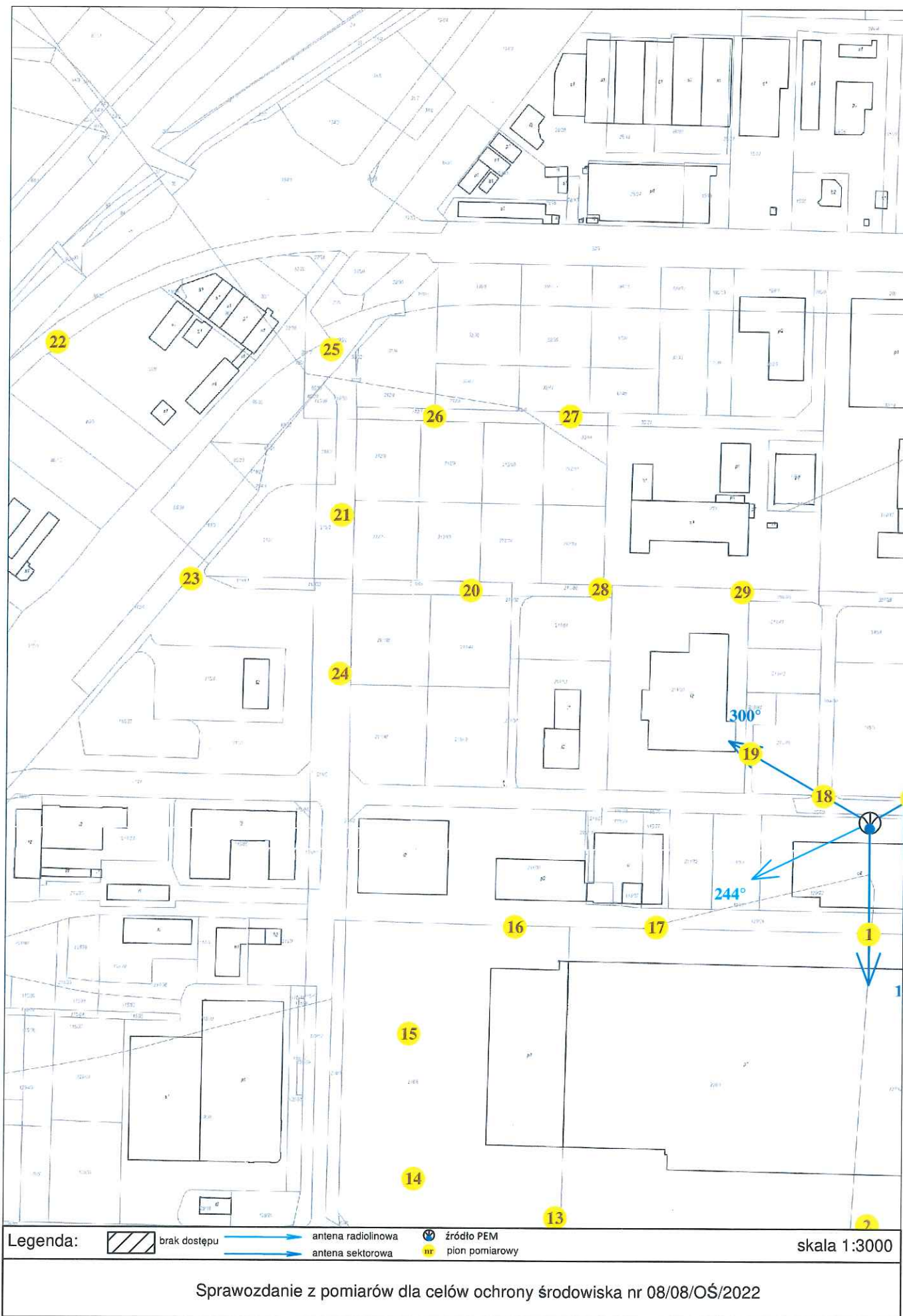
Rys. 3 Lokalizacja pionów pomiarowych
